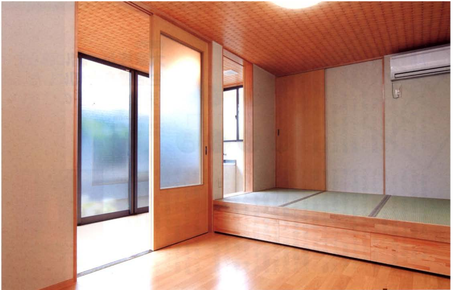
1階に設けた両親の寢室。小上がりの畳スペースの下は引き出し式の収納スペースとなっている。部屋には両親専用の納戸もあり、収納力は十分。左奥は専用のサンルーム。
